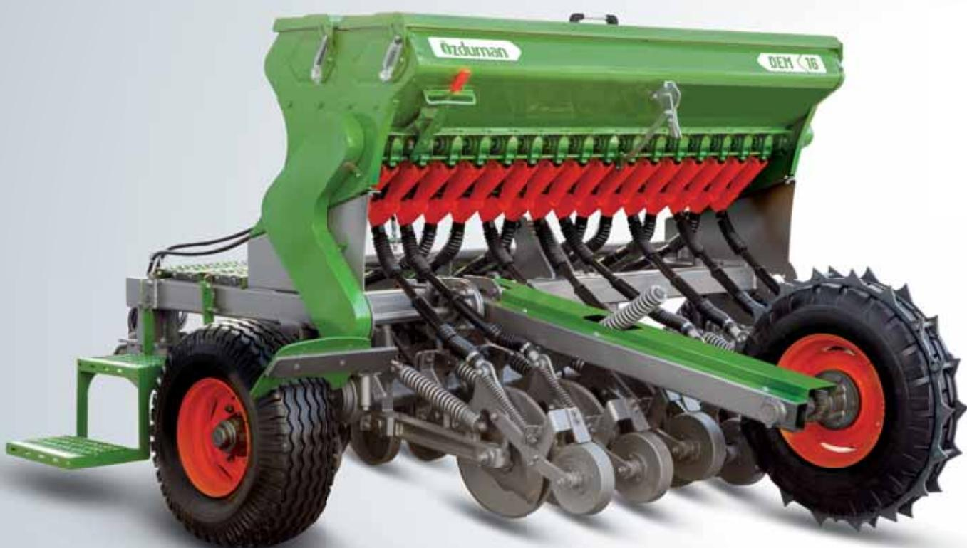
Direk aniza ekim mibzeri ile işlenmiş, yarı işlenmiş veya işlenmemiş topraklarda hububat, bakliyat ve yemlik tohumları ile gübreyi derece sistemi yardımıyla istenilen miktar ve derinlikte helisel oluklu makaralar sayesinde kesintisiz olarak disklerin açtığı tohum yatağına bırakılan kullanımı kolay çekilir tip ekim makineleridir.
