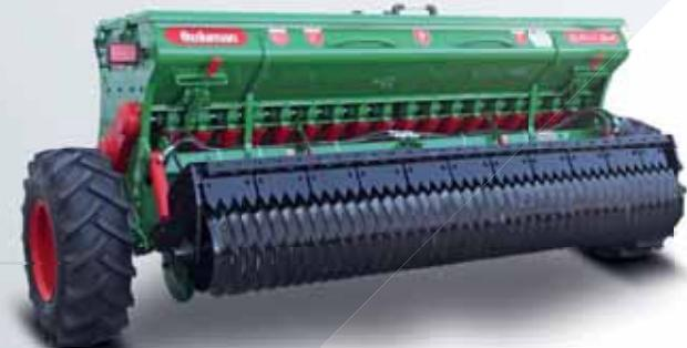
Kombine hububat mibzeri ile hububat, bakliyat ve yemlik tohumlar ile gübreyi derece sistemi yardımıyla istenilen miktar ve derinlikte helisel oluklu makaralar sayesinde kesintisiz olarak disklerin açtığı tohum yatağına bırakın kullanımı kolay çekilir tip ekim makineleridir.
